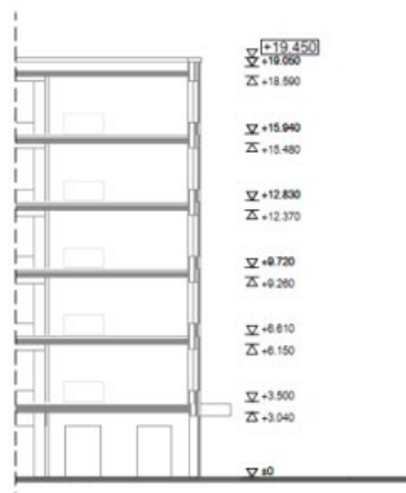
doorsnede - nieuwe gebouw (daklijn op 19,45 meter)
