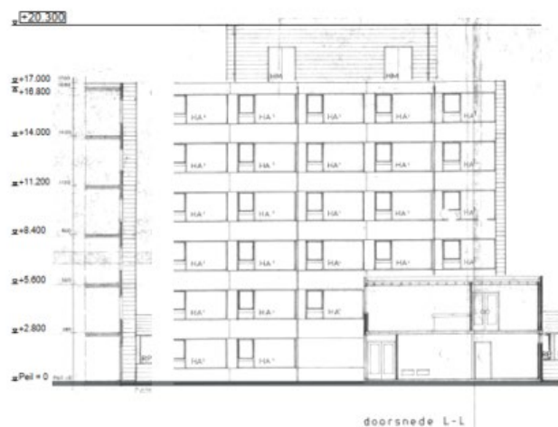
doorsnede - bestaande gebouw (daklijn op 20,3 meter)
