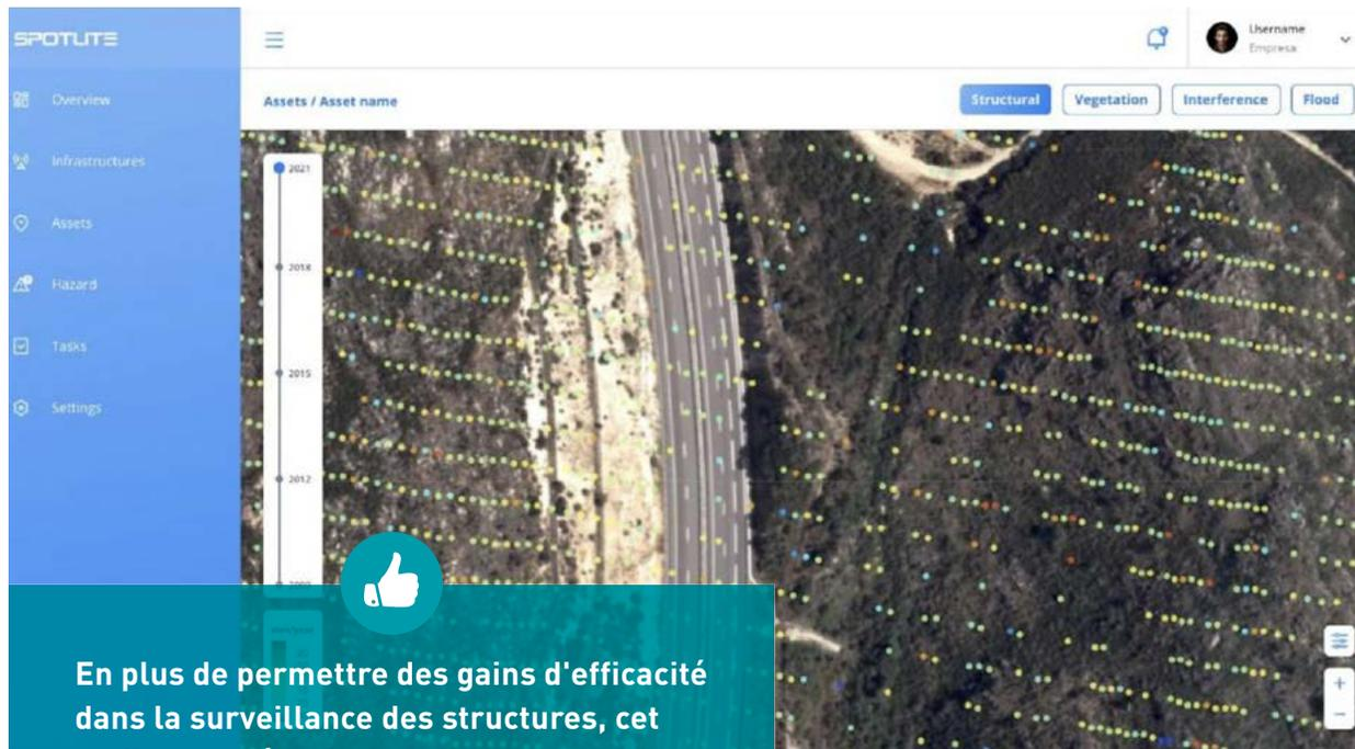
En plus de permettre des gains d'efficacité dans la surveillance des structures, cet outil peut prévenir des glissements de terrain inattendus et donc renforcer la résilience des autoroutes face aux conséquences du changement climatique.
