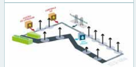
Pôle énergie et smart grid du CHU de Reims : une production centralisée et phasée (à gauche) reliée à l'ensemble des bâtiments du site par un réseau thermique intelligent (à droite). Mutualiser plutôt que multiplier les installations : le principe low-tech appliqué à l'échelle du campus hospitalier.
