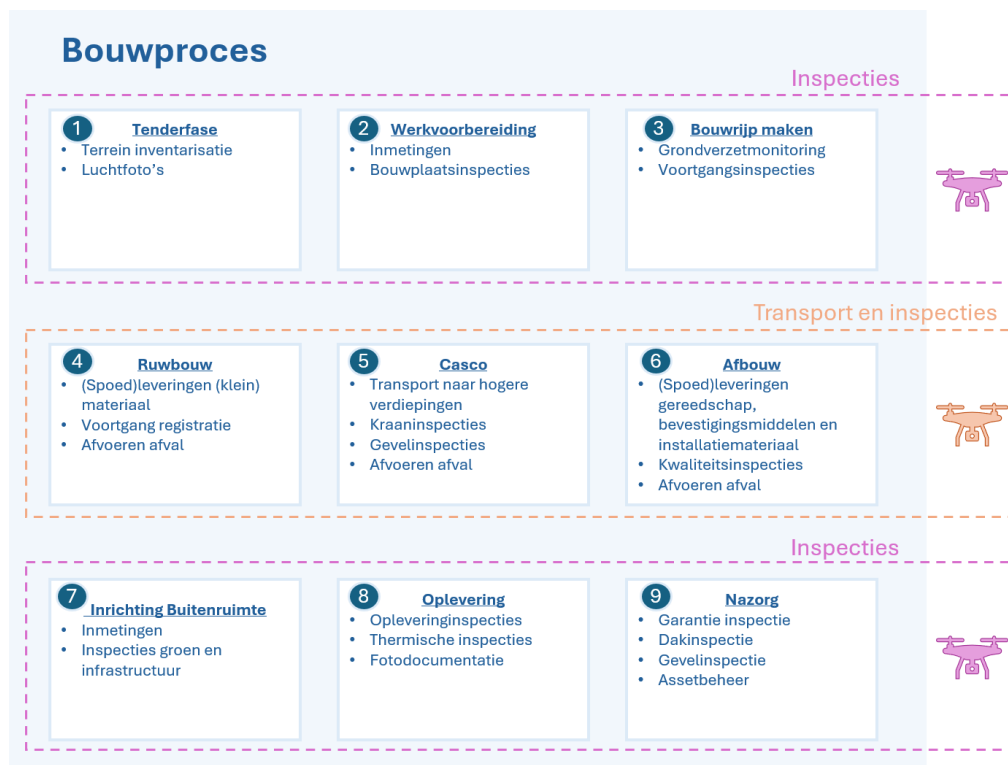
Figuur 6-1 Schematische weergave bouwproces en kansen voor dronetoepassingen
