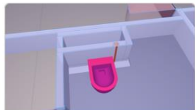
145 . Standleiding in schachtwand
